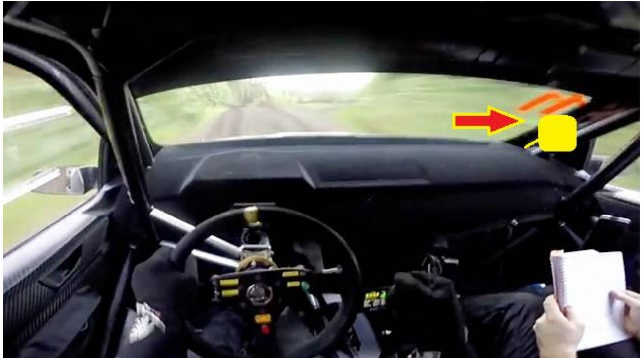
Η συσκευή θα τοποθετηθεί στην δεξιά κολώνα του εμπρόσθιου τμήματος του κλωβού ασφαλείας.
